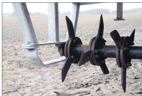
På Oxygeneratorens aksel er der monteret skær, som vinkles således, at når det trækkes op af jorden, laves der et vrid af skæret. Det efterlader mange brudflader i jorden og løsner jorden i 15-20 cm dybde. (Fotos: Kaj Lund Sørensen)
