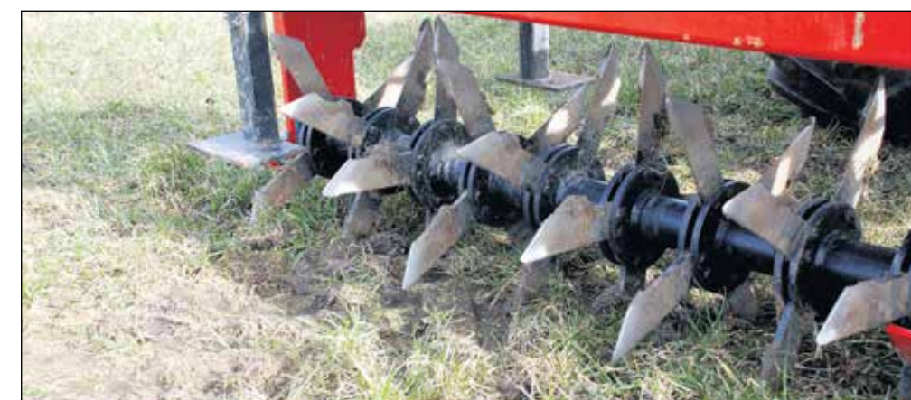
Aerator-græsflufferen fra Evers har 18 cm lange knive, der skærer ned i græsmarken. Knivene er skarpe både foran og bagud, hvilket minimerer skader på overfladen.
