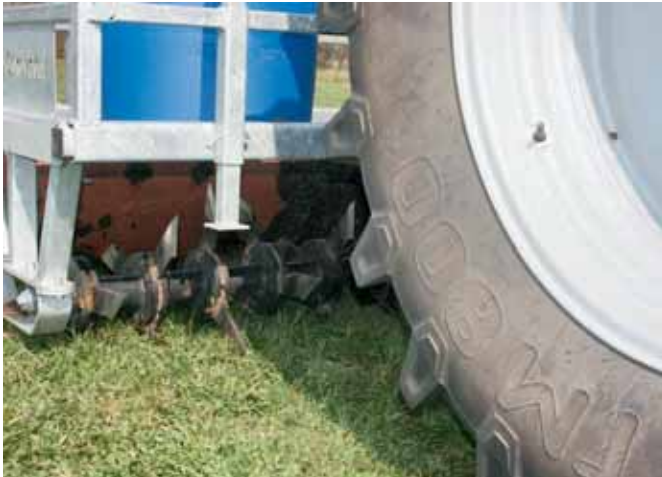
Tænderne går cirka 17 cm i jorden og river ikke jord eller græstotter op.
