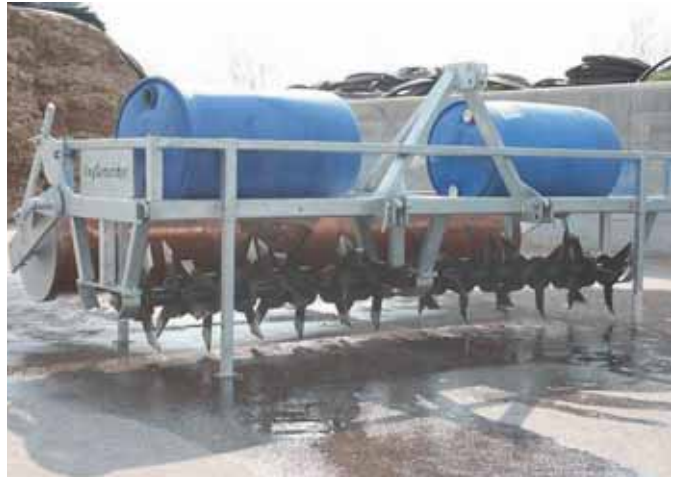
OxyGeneratoren har de to knivakslar monteret lidt på skrå, så der opnås en løsnende effekt i jorden. De to blå tønder er fyldt med vand til ballast, så den kan komme i jorden under tørre forhold.
