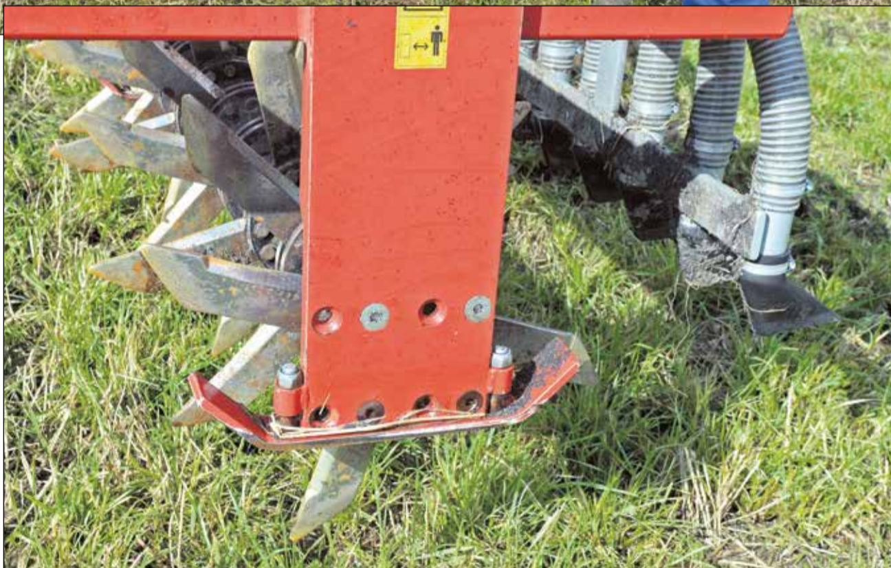
De 18 centimeter lange pigge er monteret bag på gyllevognen og laver render, hvor gyllen placeres ovenpå.
